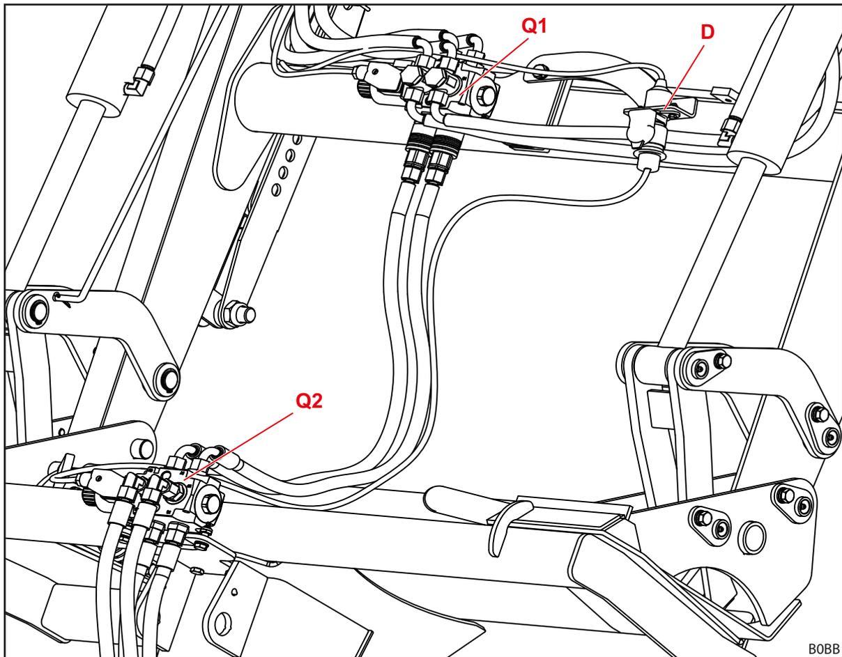
Рис. 107 Расположение гидравлических клапанов для дополнительных функций
