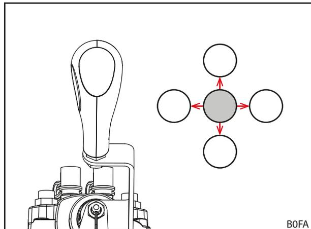
Рис. 50 Перевод рычага управления во все конечные положения
