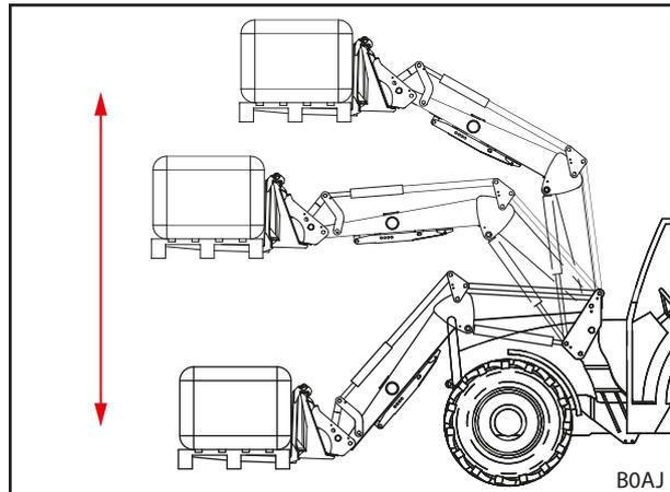
Рис. 29 Устройство параллельного ведения
