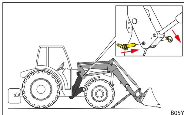
Рис. 40 Вставьте фиксирующие пальцы и закрепите их шплинтом с кольцом
