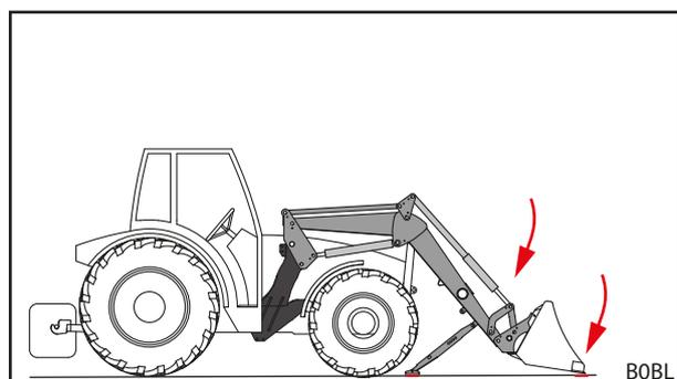
Рис. 102 Опускание фронтального погрузчика и опрокидывание рабочего органа
