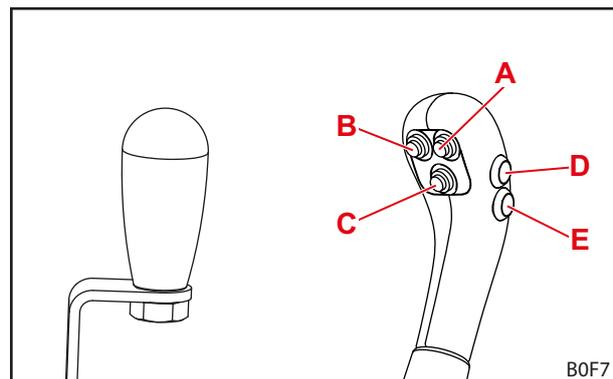
Рис. 47 Рычаг управления без кнопок (слева) и рычаг управления с 5 кнопками (справа)
