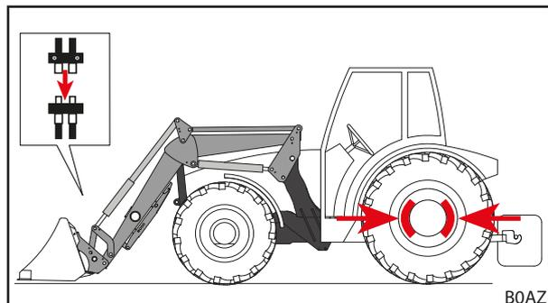
Рис. 77 Подсоединение линии гидравлики
