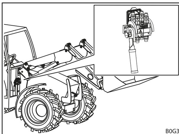
Рис. 16 Hydro-Fix: положение на погрузчике
