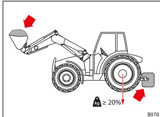
Рис. 34 Нагрузка при работе с погрузчиком
