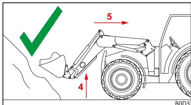
Рис. 95 Движение задним ходом с грузом – правильно
