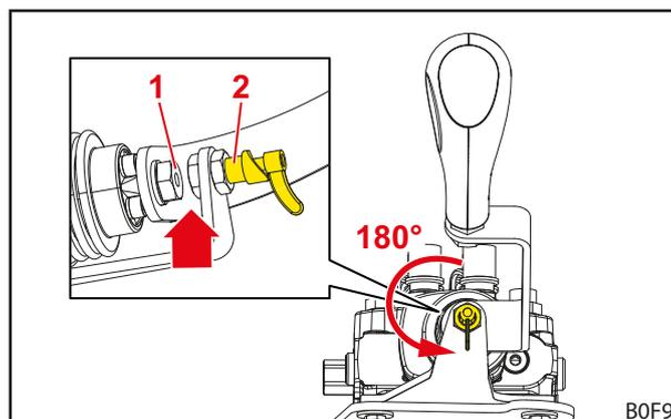
Рис. 49 Разблокированный рычаг управления
