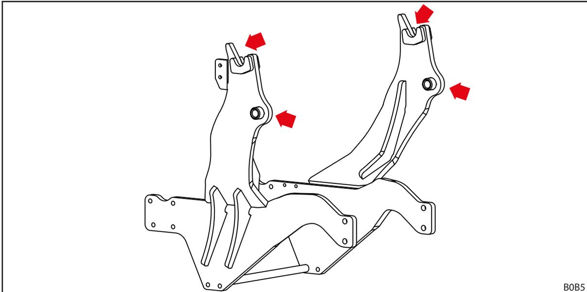
Рис. 96 Точки смазки посадочных мест погрузчика
