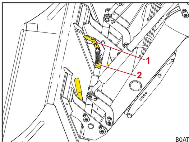
Рис. 61 Механический запирающий механизм рабочего органа на раме Skid-Steer (зафиксированное состояние с рабочим органом)
