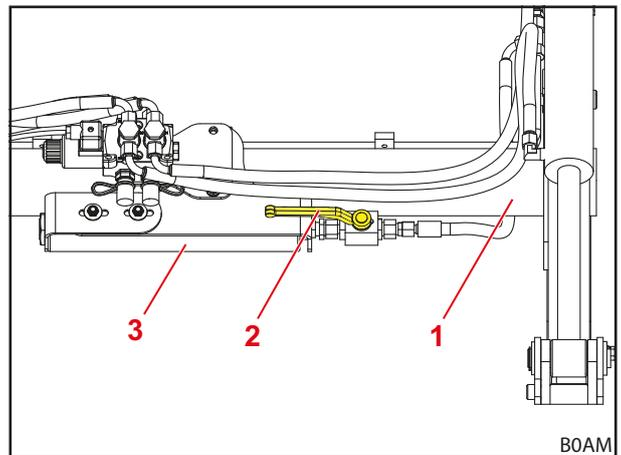
Рис. 32 Comfort-Drive с ручным управлением (рычаг в положении включения Comfort-Drive)
