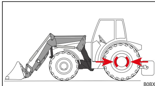
Рис. 87 Установка рабочего органа в положение для снятия и активация стояночного тормоза
