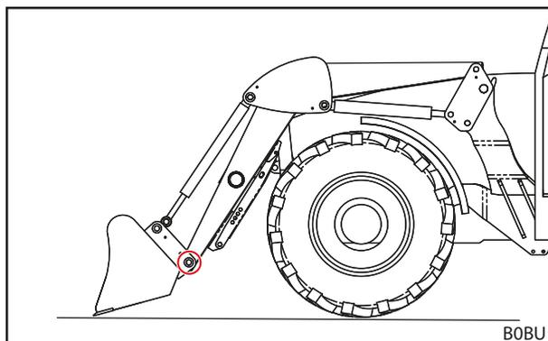
Рис. 79 Соединение рабочего органа через нижние отверстия для пальцев
