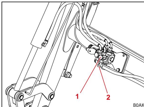
Рис. 30 Дополнительная 3-я линия гидравлики
