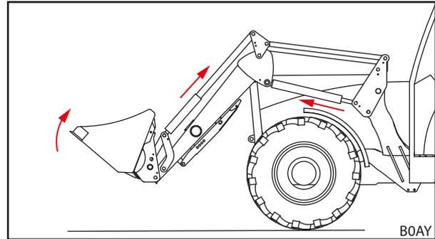
Рис. 71 Срабатывание запирающего механизма рабочего органа
