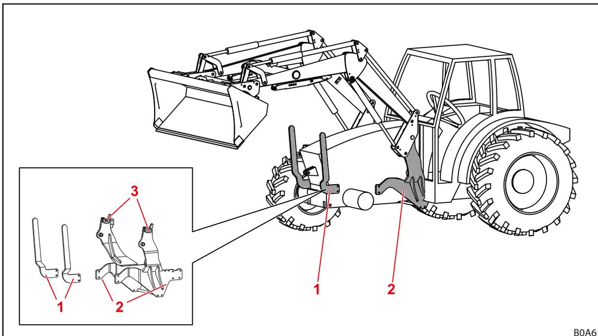
Рис. 10 Монтажный комплект для трактора
