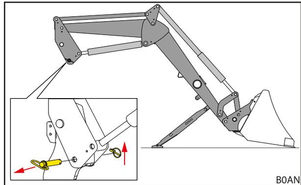
Рис. 37 Открытие запирающего механизма погрузчика
