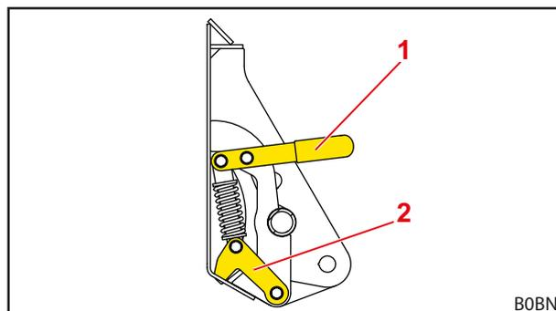
*Рис. 58 Механический запирающий механизм рабочего органа на раме Skid-Steer (открытое состояние)*
