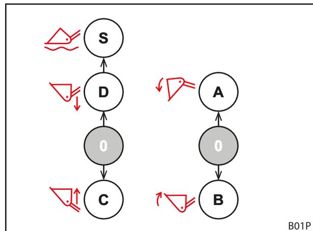
Рис. 43 Назначение с 2 рычагами управления
