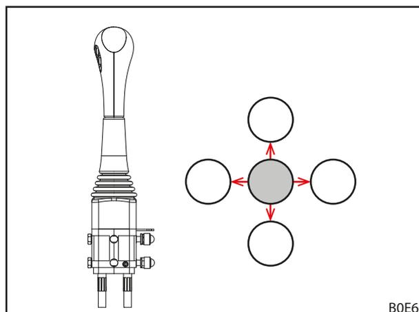
Рис. 46 Перевод рычага управления во все конечные положения
