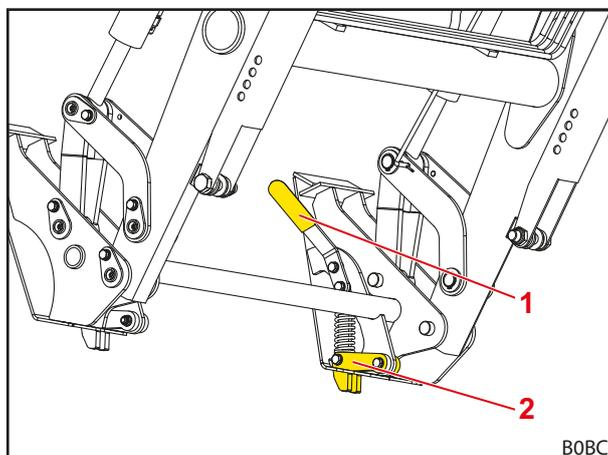
Рис. 62 Механический запирающий механизм рабочего органа на раме Skid-Steer (зафиксированное состояние без рабочего органа)
