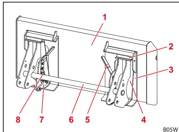
Рис. 21 Закрытый запирающий механизм
