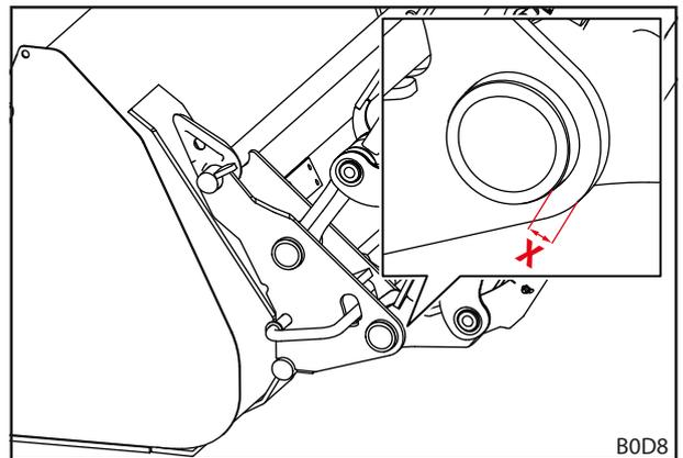
Рис. 100 Степень износа сменной рамы
