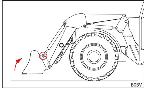
Рис. 80 Соединение рабочего органа сверху с гидравлическими цилиндрами
