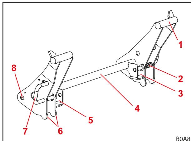
Рис. 64 Запирающий механизм рабочего органа на сменных рамах Euro
