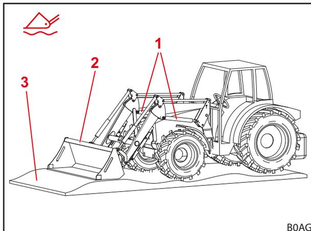
Рис. 27 Фронтальный погрузчик в плавающем положении
