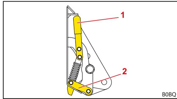
Рис. 60 Механический запирающий механизм рабочего органа на раме Skid-Steer (зафиксированное состояние)
