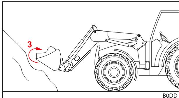
Рис. 93 Отклонение рабочего органа назад и загрузка груза
