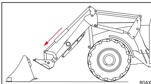
Рис. 69 Установка стрелы в нужное положение
