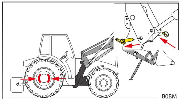
Рис. 101 Затягивание стояночного тормоза и ослабление запирающего механизма фронтального погрузчика
