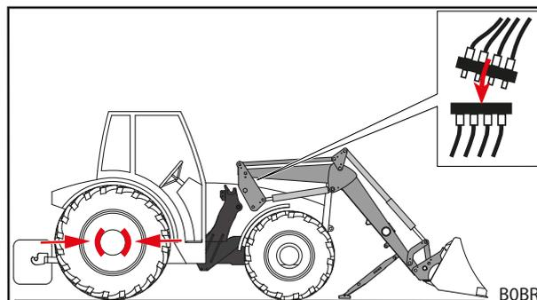
Рис. 103 Отсоединить гидравлику
