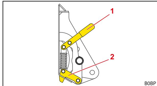
Рис. 59 Механический запирающий механизм рабочего органа на раме Skid-Steer (полуоткрытое состояние)
