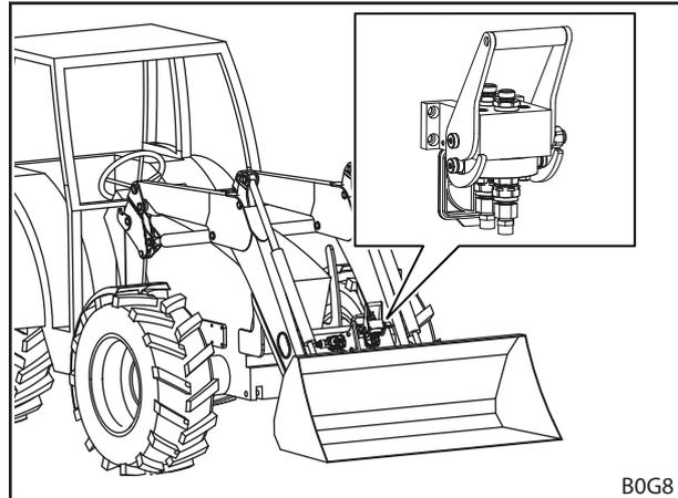
Рис. 18 Implement-Fix: положение на погрузчике
