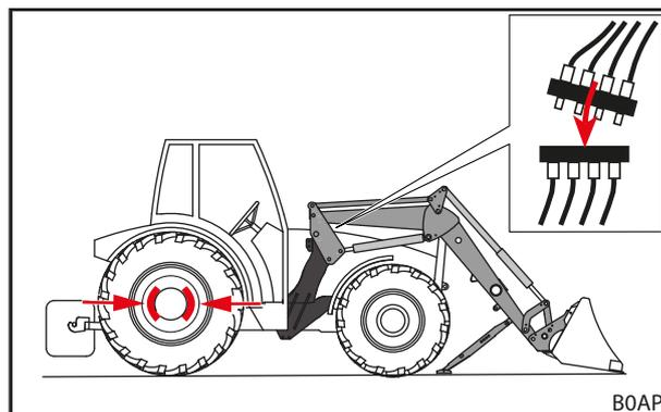
Рис. 39 Выключение трактора и подключение гидравлических шлангов
