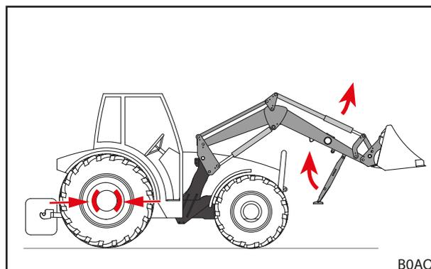
Рис. 41 Складывание стояночных опор
