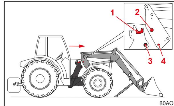
Рис. 38 Заезд трактором в стрелу
