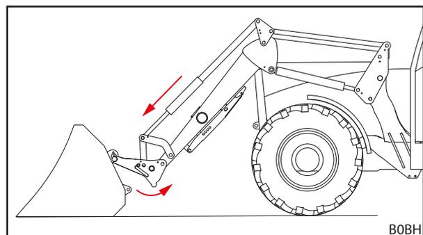
Рис. 85 Снятие сменной рамы
