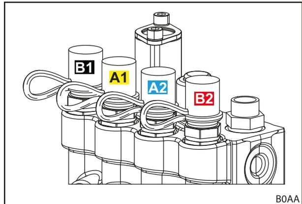
Рис. 15 Штекеры штекерных муфт прямо на гидравлическом клапане
