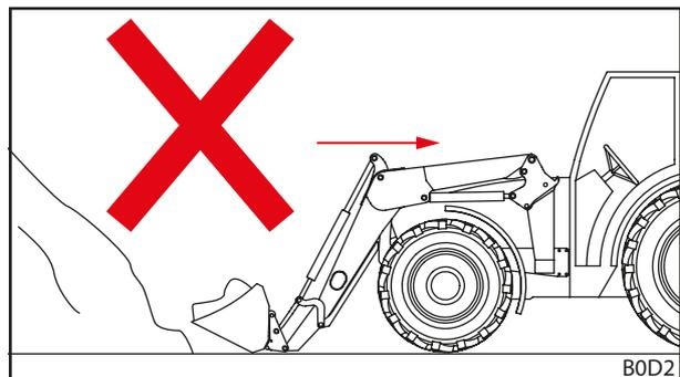
Рис. 94 Движение задним ходом с грузом – неправильно
