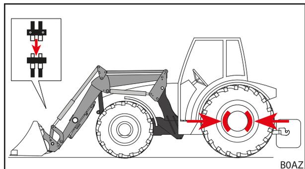
Рис. 82 Подсоединение линии гидравлики
