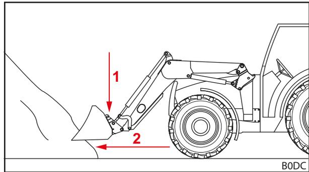
Рис. 92 Опустите погрузчик и заедьте в загружаемый материал по прямой
