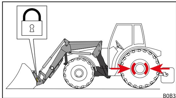
Рис. 76 Закрытие запирающего механизма рабочего органа
