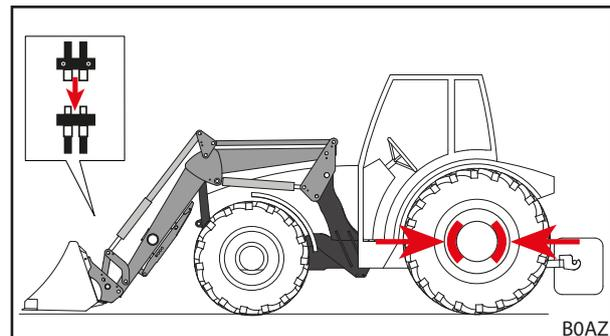
Рис. 72 Подсоединение линии гидравлики
