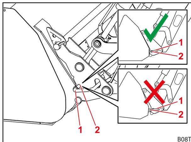
Рис. 65 Проверка положения фиксирующих пальцев
