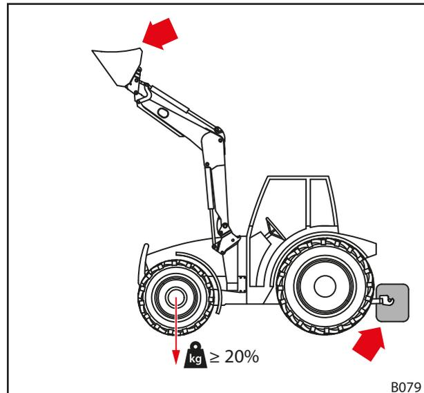
Рис. 35 Нагрузка при движении по дорогам
