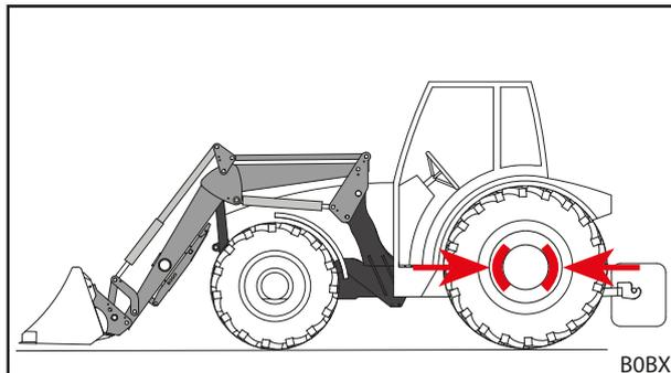
Рис. 83 Установка рабочего органа в положение для снятия и активация стояночного тормоза
