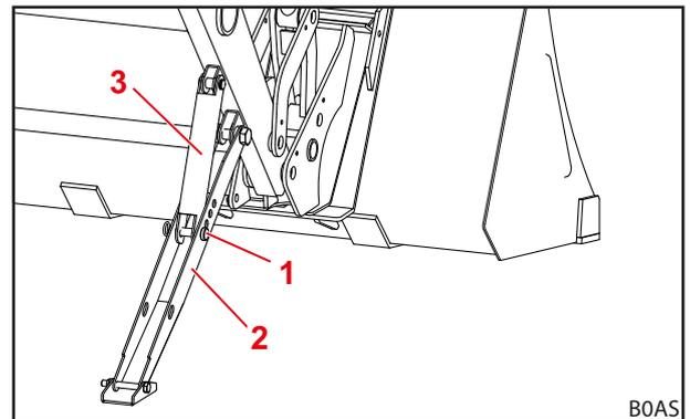
Рис. 52 Стояночная опора разложена
