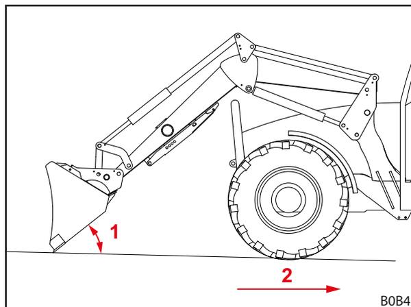
Рис. 91 Планировка задним ходом
